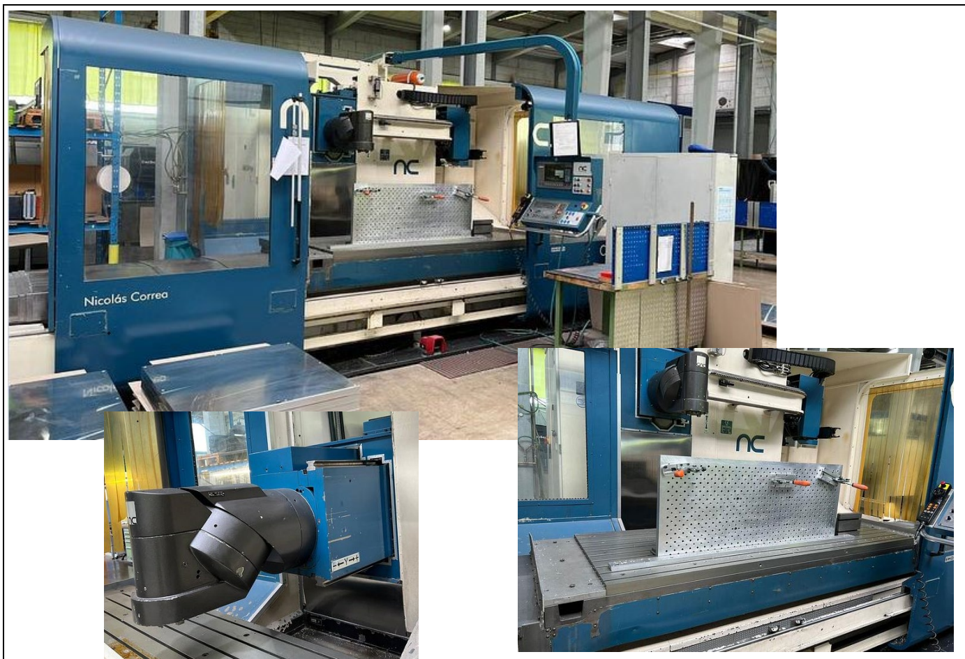
Fresadora CORREA CF 25/25 (Antes de su reconstrucción)
