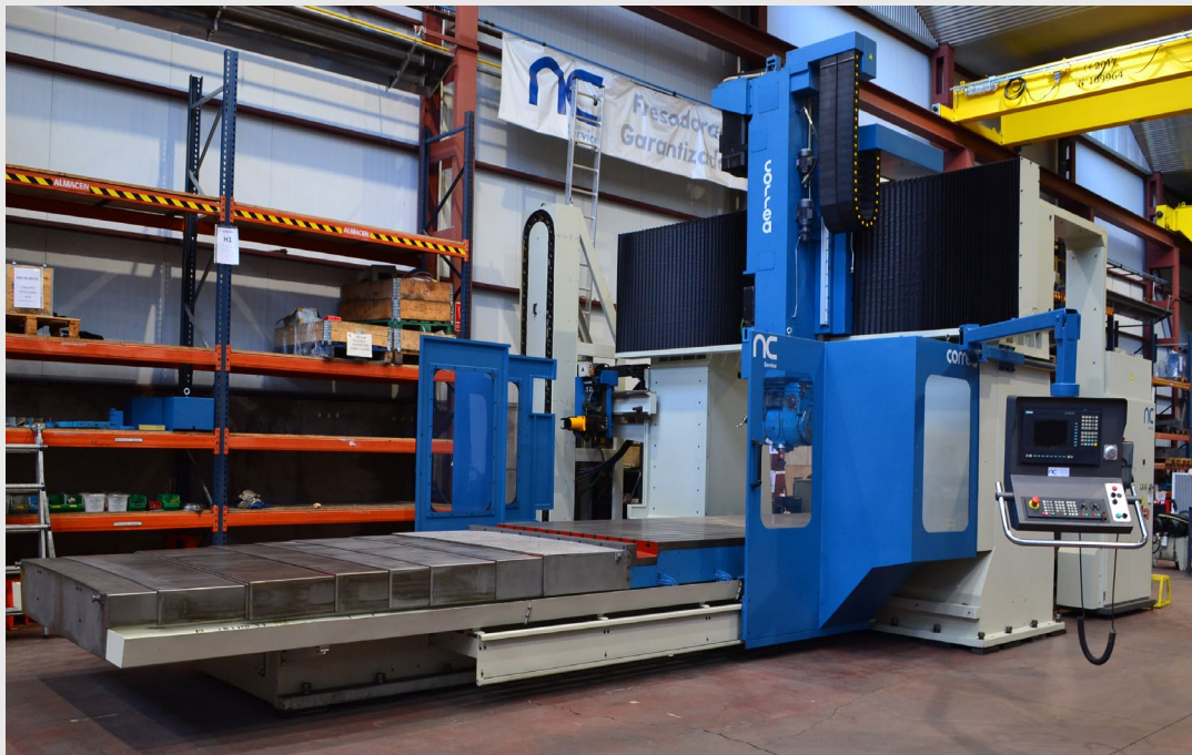
Fresadora CORREA FP 40/50 durante su reconstrucción por CORREA Service
