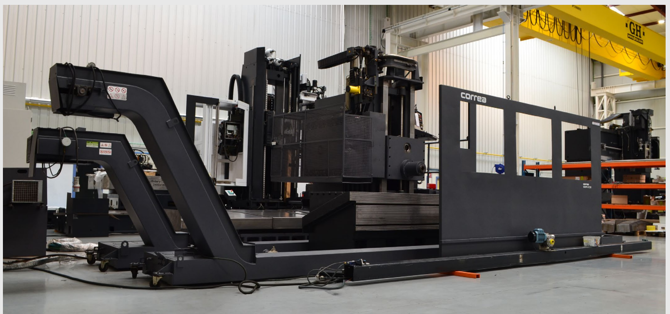
ANAYAK HVM-6000 durante su proceso de reconstrucción mecánica
