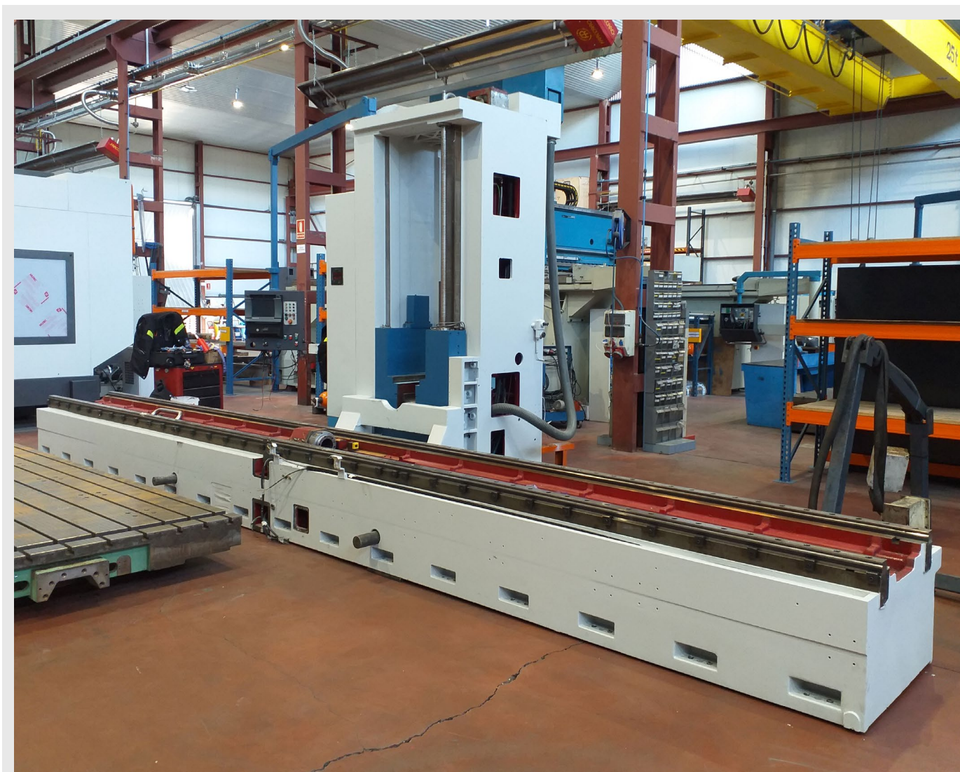
Fresadora CORREA A 30/40 durante su total reconstrucción
