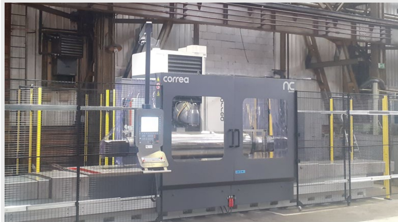
Ejemplo fresadora CORREA A30/40 reconstruida con nuevo TNC320 y nuevo cabezal UDG
