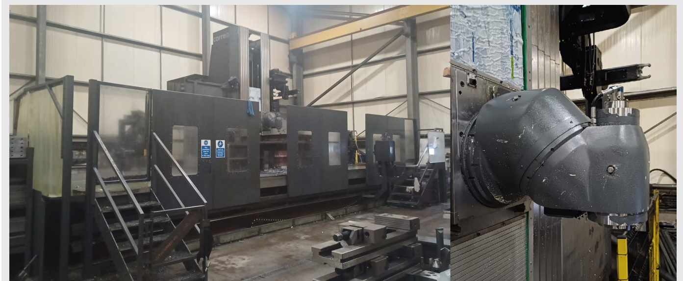
Fresadora columna móvil CORREA AXIA 100 en origen, antes de su reconstrucción
