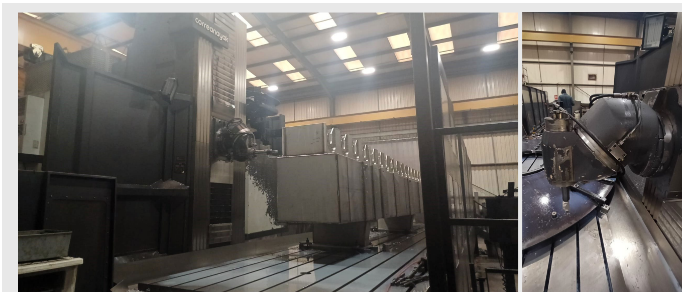
Fresadora columna móvil CORREA AXIA 115 en origen, antes de su reconstrucción
