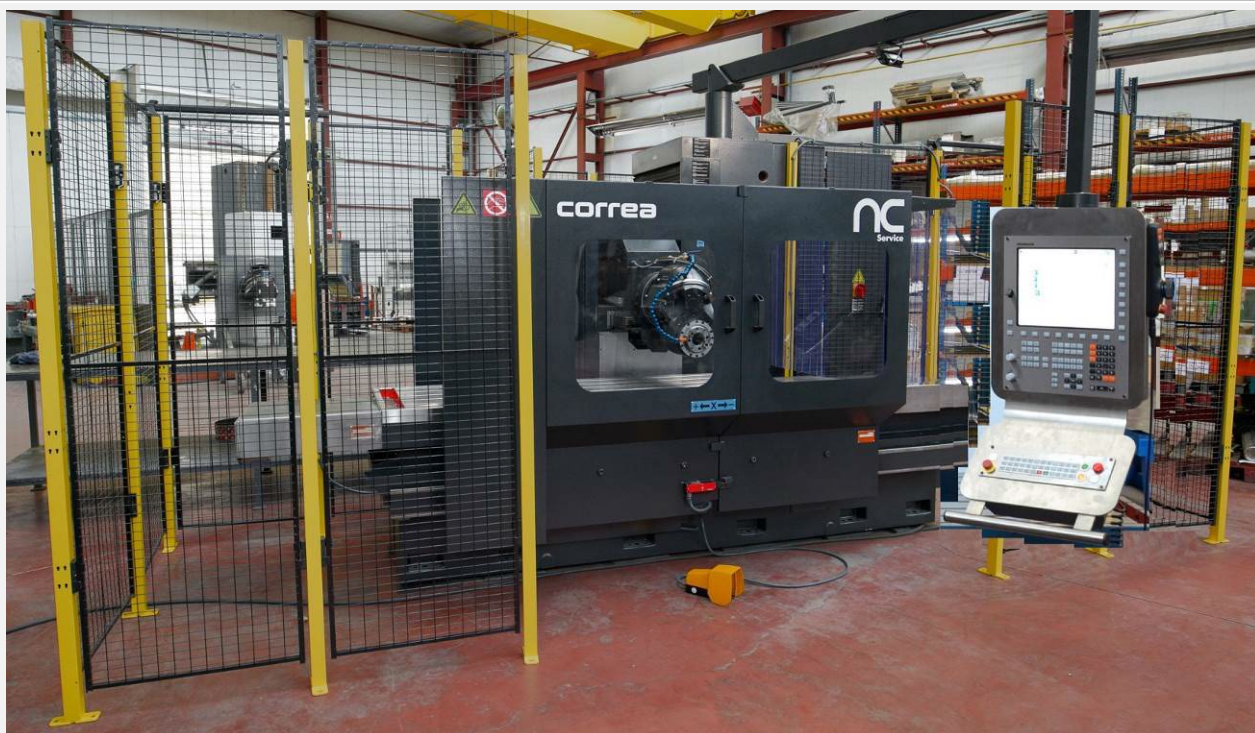
Ejemplo de fresadora CORREA CF22/20 tras su reconstrucción y nuevo TNC-320
