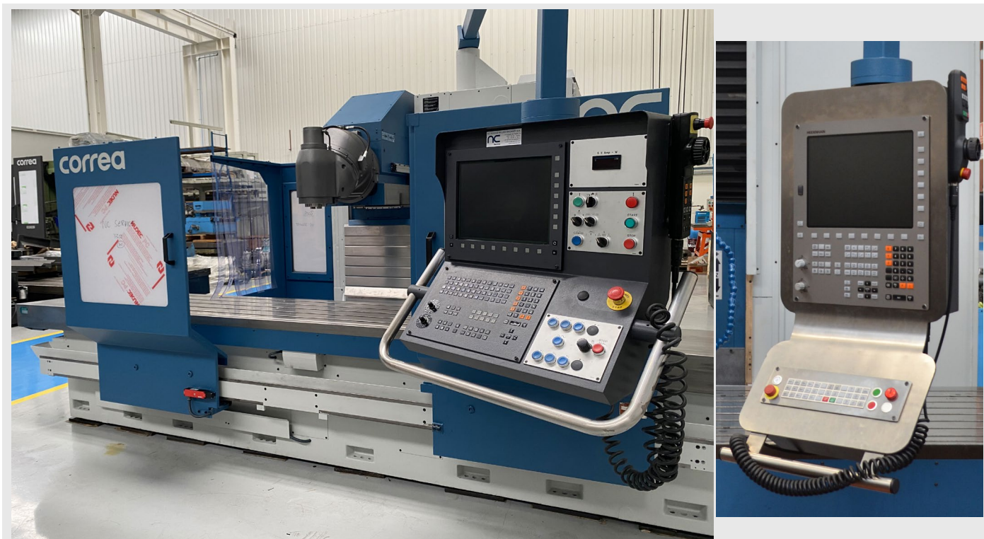
Ejemplo de CORREA CF22/25-Plus reconstruida con cabezal UDG (2,5°). Nuevo TNC-320
