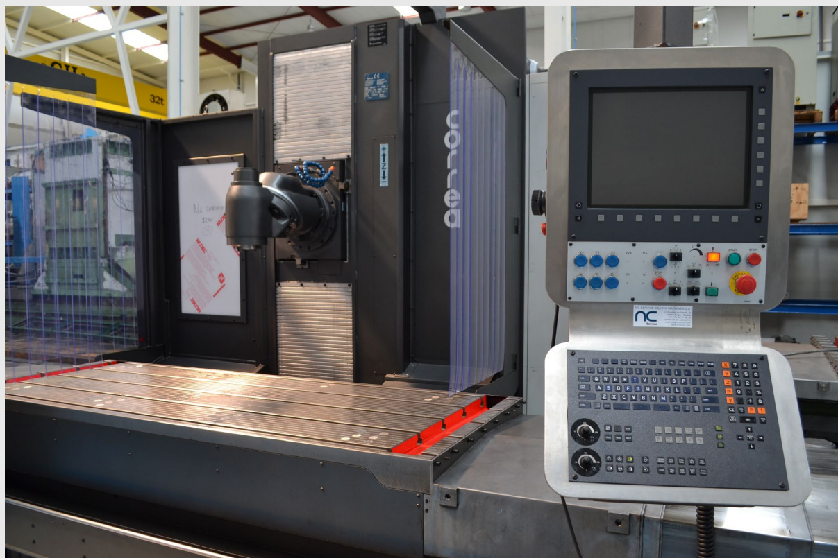
Ejemplo de fresadora CORREA DIANA 20 con cabezal manual tras su reconstrucción
