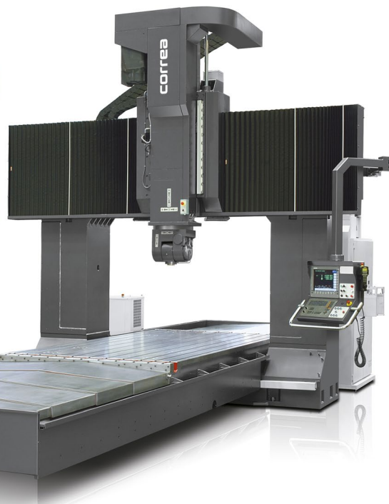
Ejemplo de fresadora CORREA FP40/40 y detalle de cabezal C5E de 5 ejes continuo
