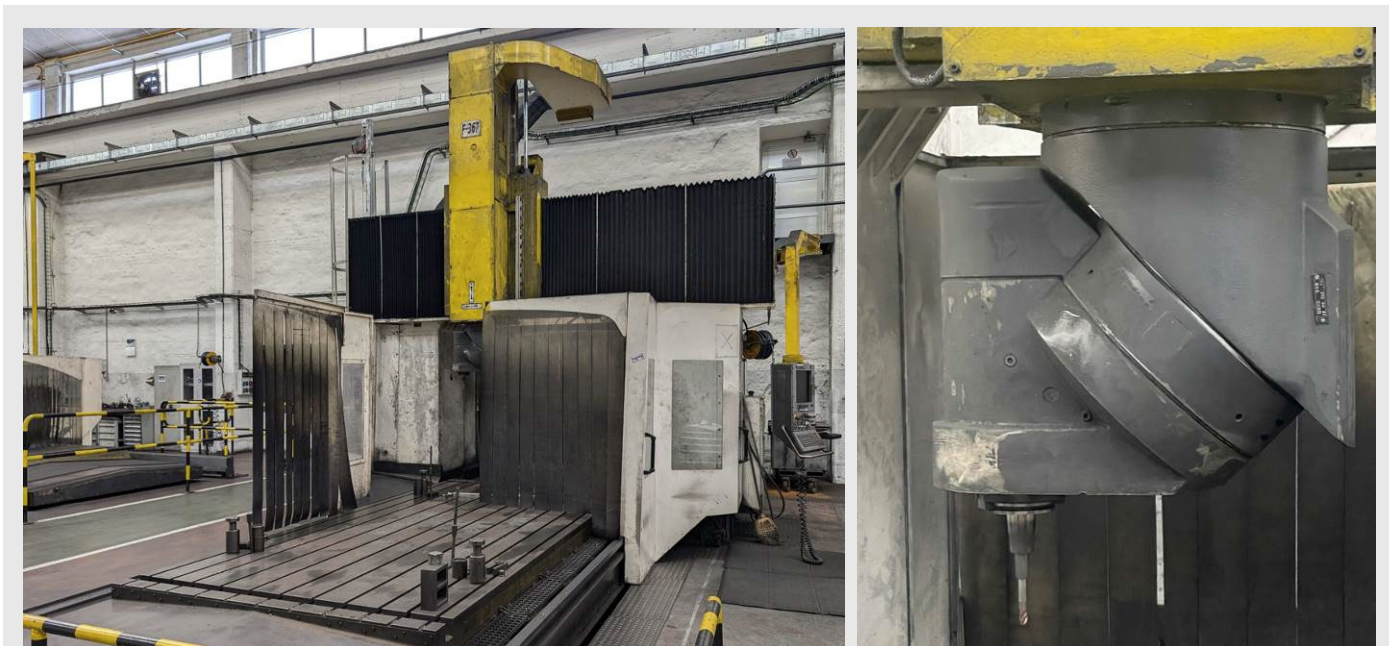
Fresadora CORREA FP 40/40 antes de su reconstrucción (en origen)
