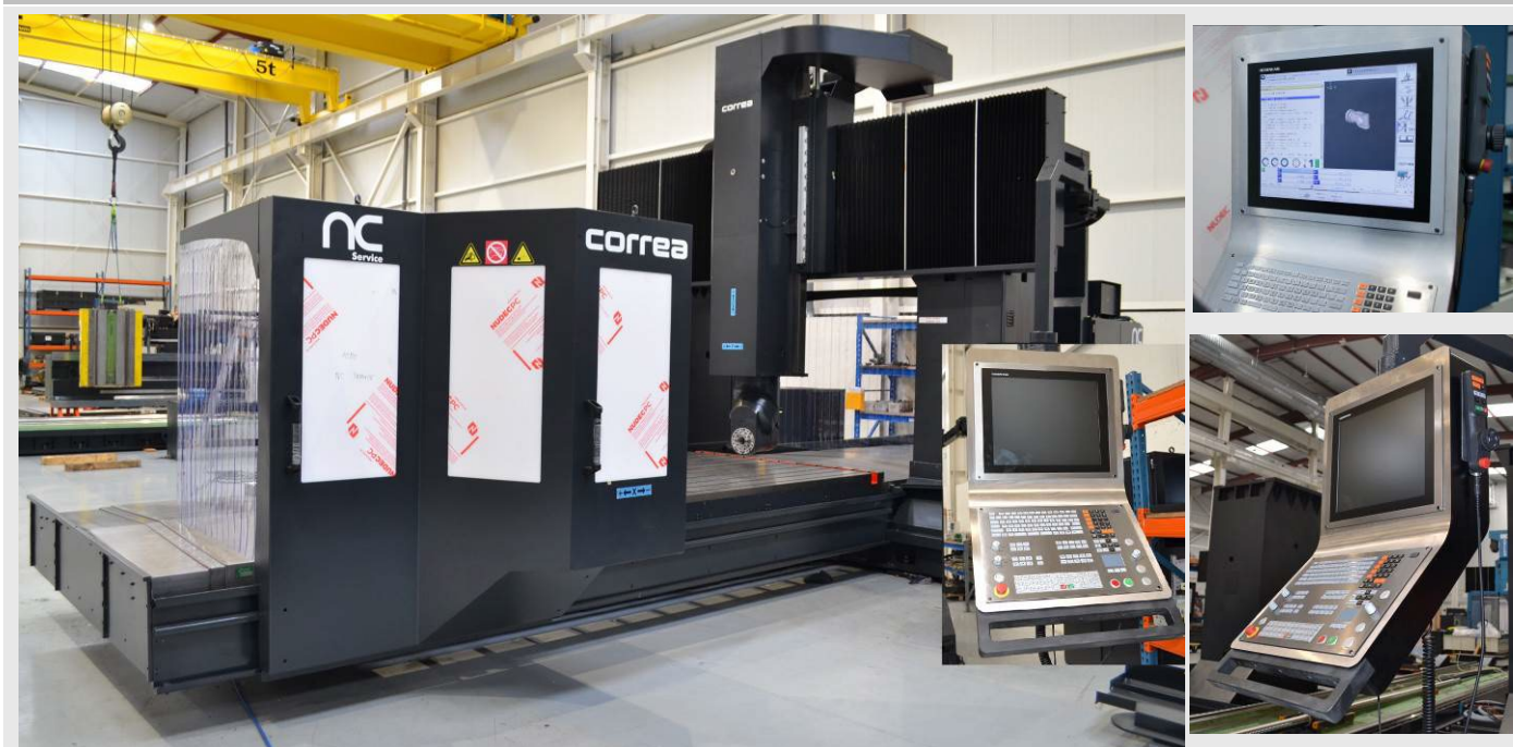
Ejemplo de fresadora CORREA FP 40/40 durante su reconstrucción y de nuevo TNC-i640
