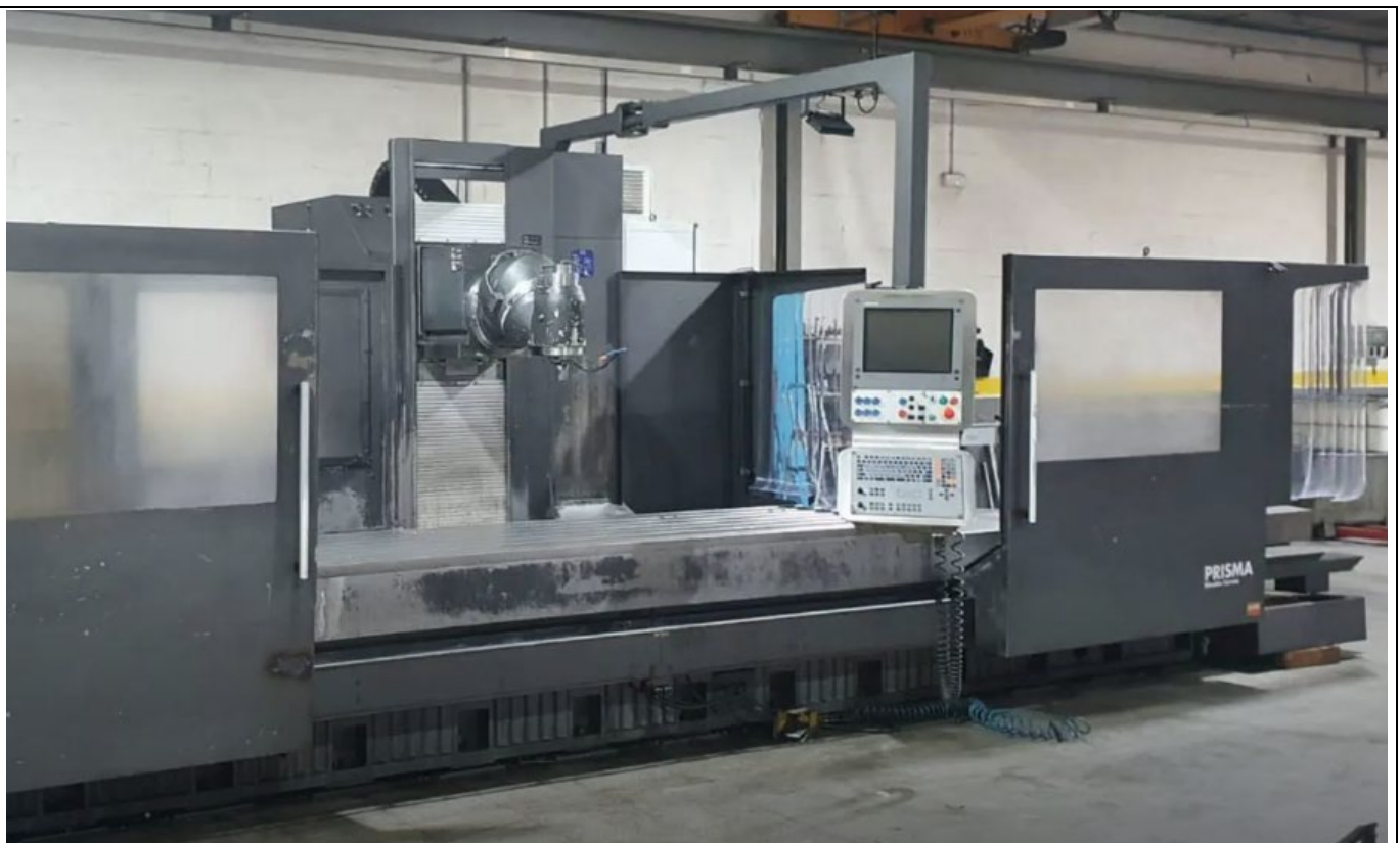
Fresadora CORREA PRISMA 35 (previo a su retrofitting)
