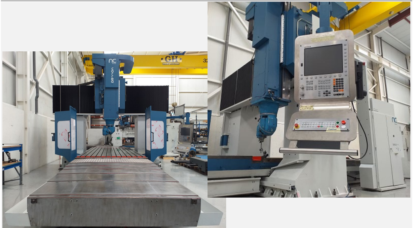
Ejemplo de fresadora CORREA FP40 tras su total retrofiting con nuevo TNC-320
