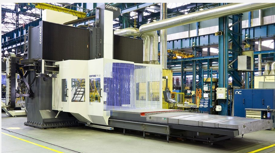
Ejemplo de fresadora CORREA FP50/50 tras su reconstrucción con opción de ATC
