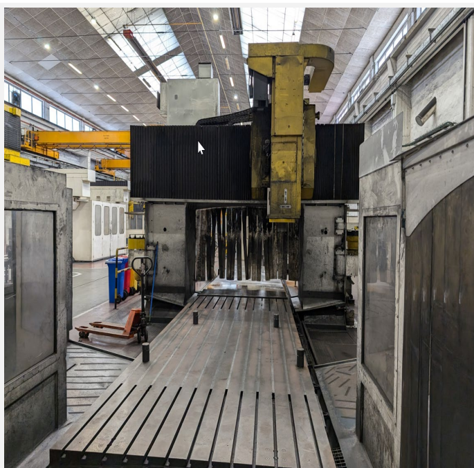
Fresadora CORREA FP50/50 antes de su reconstrucción (en origen)
