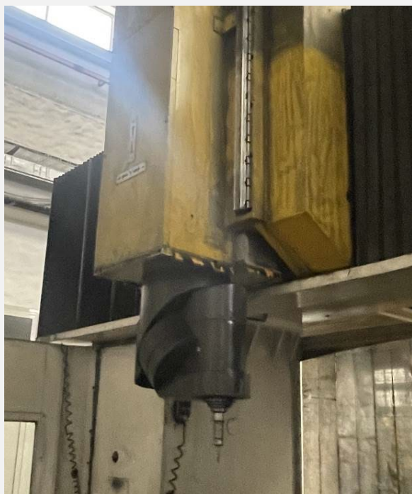
Fresadora CORREA FP 50/50 antes de su reconstrucción (en origen)
