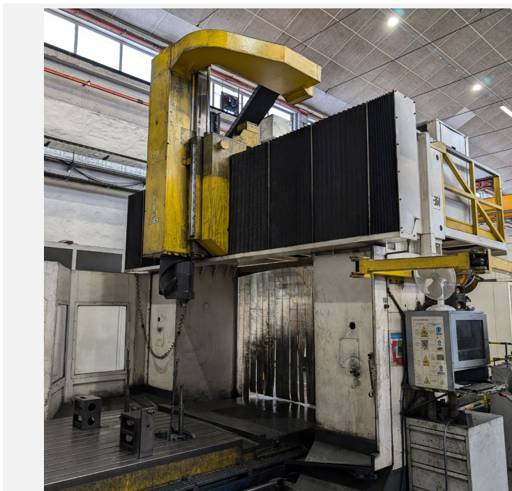
Fresadora CORREA FP 50/50 antes de su reconstrucción (en origen)
