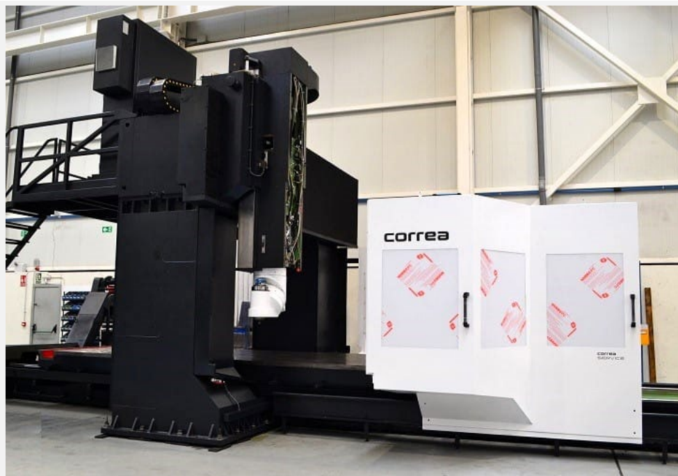
Fresadora CORREA FP 50/50 durante su reconstrucción (ATC opcional)
