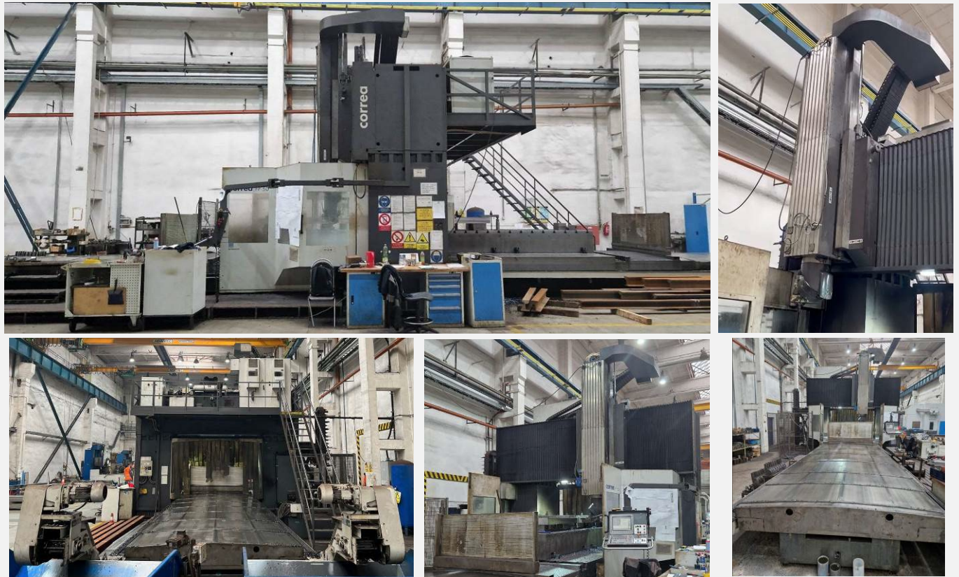
Fresadora CORREA FP50/80 antes de su reconstrucción (en origen)
