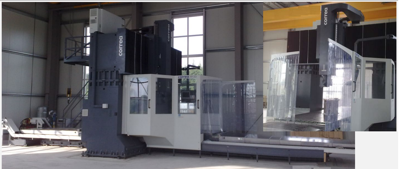
Ejemplo de fresadora CORREA FP50/80 tras su reconstrucción
