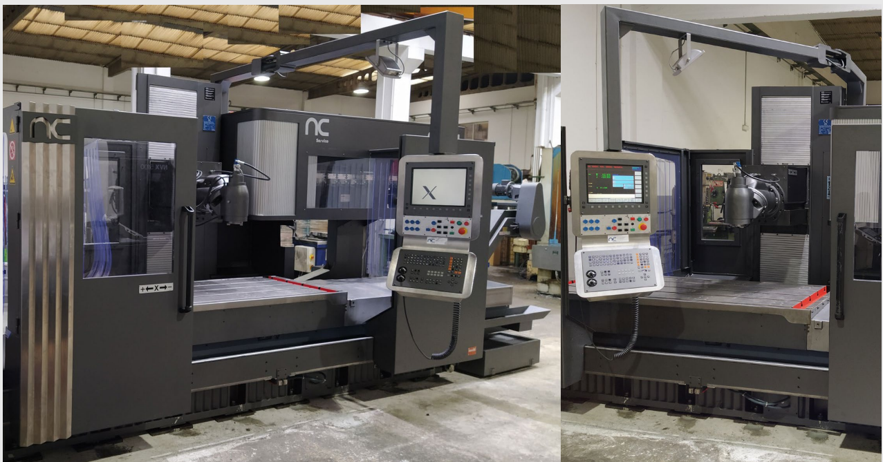
Ejemplo de fresadora CORREA PRISMA 25 tras su reconstrucción
